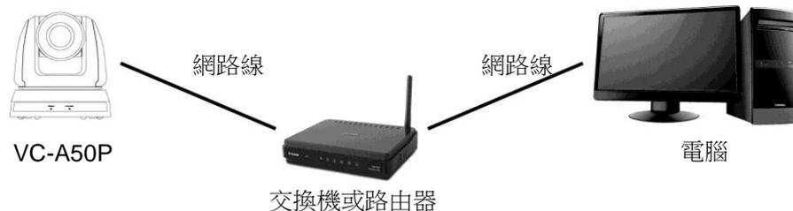
2. 通過網路線直接連接，須修改電腦之 IP 位址同攝像機使用之網段，例：[192.168.100.x](http://192.168.100.x)(攝像機預設)
